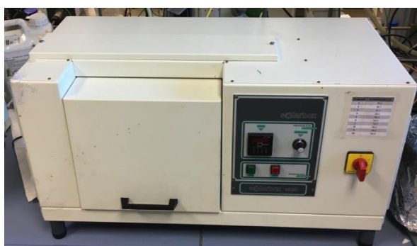
Figura 3. Instalación utilizada como fuente de radiación solar (Solar Box 1500)
