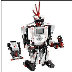
Ilustración 4 LEGO® MINDSTORMS® EV3 - fuente:
