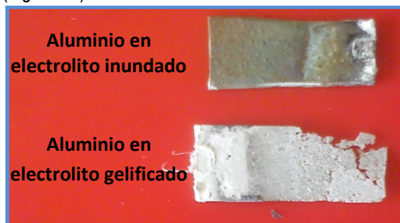
Figura 26. Aspecto final de las muestras de Al2024Unclad en pila inundada y gelificada
