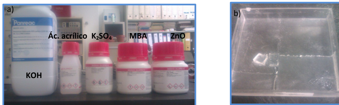
Figura 4. a) Reactivos para la síntesis del gel; b) Electrolito gelificado;
