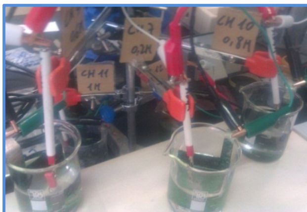
Figura 15. Ensayos simultáneos de potencia de la pila Al 2024 Unclad/NiOOH, en KOH 0,2M.
