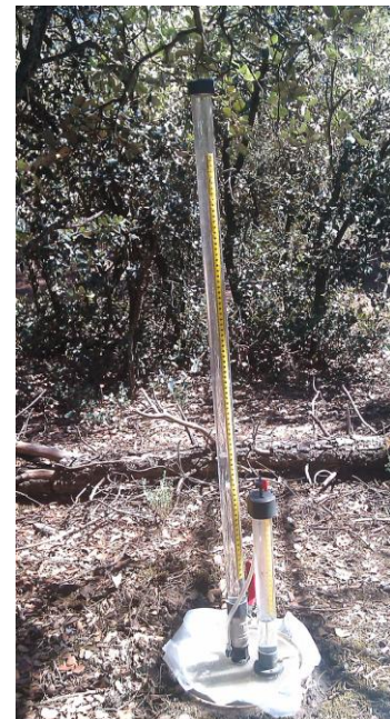
Figura 10.a. Infiltración media en los diferentes usos del suelo. b. Imagen del ensayo en campo de la infiltración.
