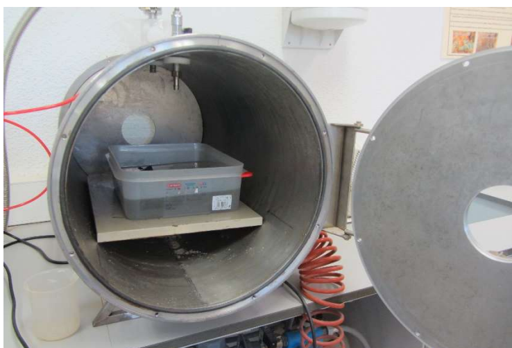
Figura 103. Protección de la pieza con Paraloid al 3% en acetona-xileno, en cámara de vacío. © SECYR. 2016
