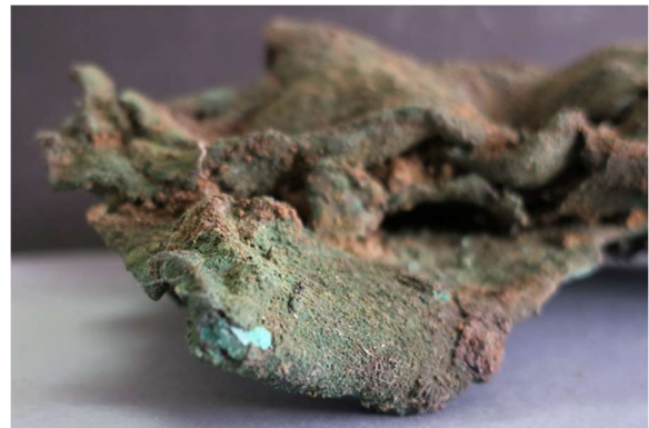
Figura 35. Vista de perfil, donde se observa la pérdida de material y la mineralización interna de la pieza. ©M. Turégano. 2016
