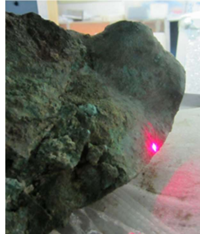
Figura 72. Análisis de la superficie ya limpia de productos e corrosión con la técnica LIBS. ©SECYR. 2016
