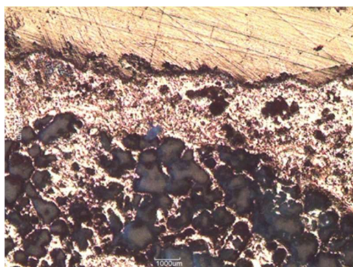
Figura 57. Muestra F. Fotomicrografía tomada por el estereomicroscopio, 90X. Ausencia núcleo metálico. © I. Donate. 2014
