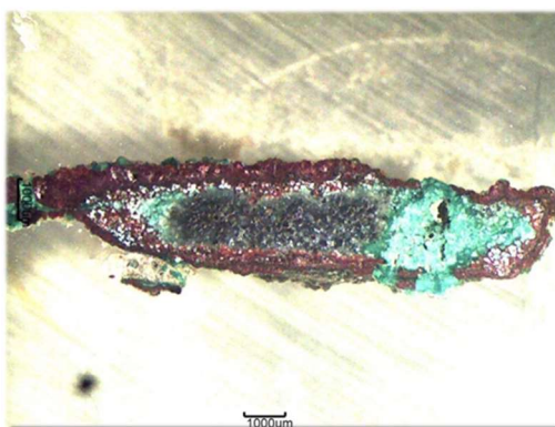
Figura 55. Muestra F I analizada para identificar la estratigrafía de la corrosión. Se observa la ausencia total de núcleo metálico. © I. Donate. 2014
