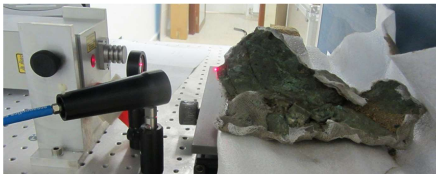
Figura 43. Análisis con el equipo de LIBS sobre la superficie para identificar los depósitos superficiales. ©I. Donate.2014
