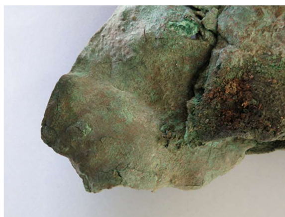
Figura 70. Detalle de la limpieza de la parte inferior. Se observa la ausencia de capa de tenorita y el foco de cloruro de cobre aún sin limpiar. © M. Turégano. 2016
