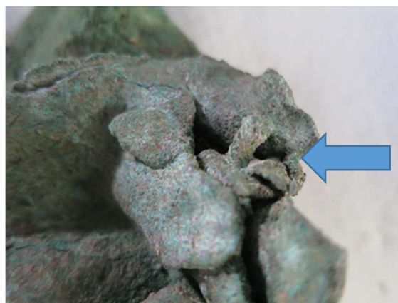
Figura 96. Remache que apareció después de la limpieza. © M. Turégano. 2016
