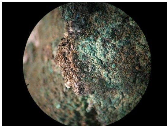
Figura 39. Fotomicrografía de una de las grietas de la superficie de la Cara A, con cloruros de cobre al rededor. ©M.Turégano.2013
