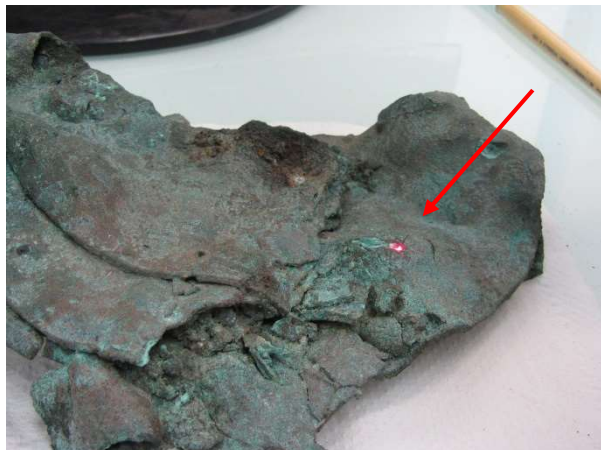
Figura 102. Estabilización de cloruros de cobre con la técnica láser. © SECYR. 2016
