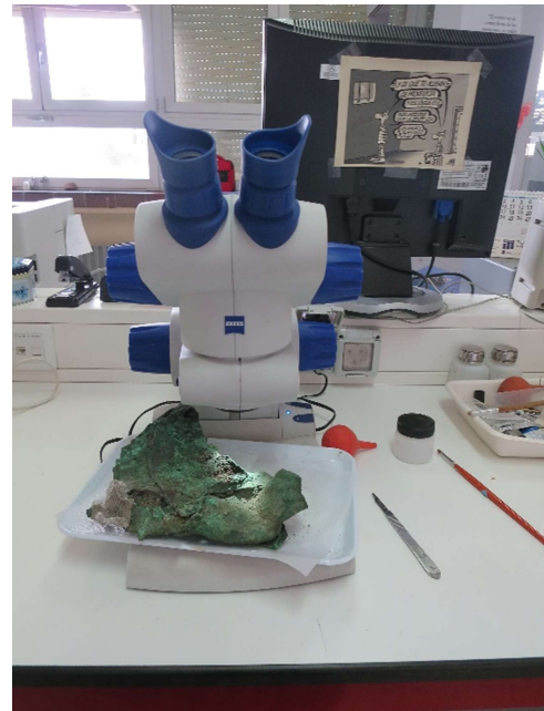
Figura 21. Examen bajo el binocular del estado de conservación. Laboratorio Docente de Arqueología y Prehistoria (UAM). ©M.Turégano 2015.
