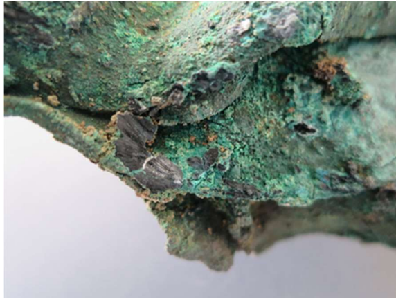
Figura 77. Restos de carbones en el contorno de la pieza; bajo estos se puede ver la aparición de cloruros de cobre. © M. Turégano. 2016
