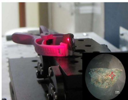
Figura 44. Análisis con LIBS del fragmento desprendido. © I. Donte. 2014
