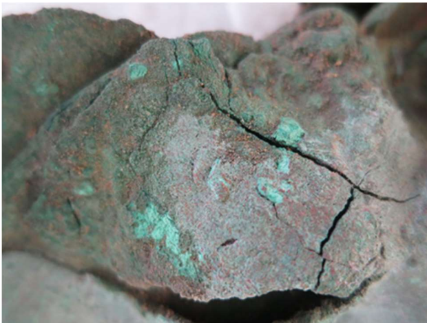
Figura 95. Cloruros de cobre activos. © M. Turégano. 2016
