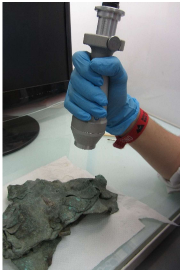
Figura 101. Limpieza láser de la pieza. © SECYR. 2016
