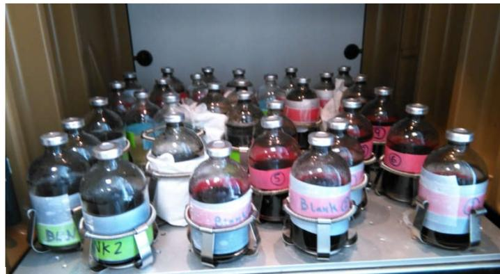
Figura 4. Montaje de digestores batch en incubadora
