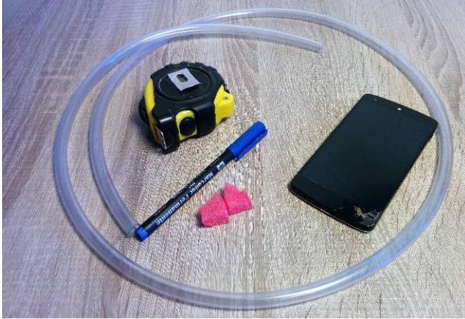
Figura 6.4. Material entregado a cada equipo para el experimento de la burbuja de aire en la tubería: metro o regla, rotulador indeleble, un móvil por grupo, tubo transparente de metro y medio de largo con agua dentro y taponado con corchos o gomas. Debe dejarse una pequeña burbuja de aire dentro.
