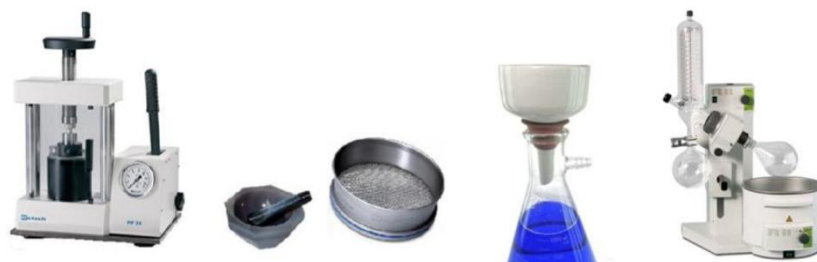
Figura 6. Equipos empleados (de izq. a der.): prensa hidráulica, mortero, tamiz, kitasato con büchner y rotavapor.
